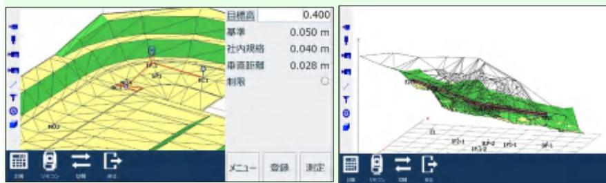
i-Construction対応 締固め管理システム
